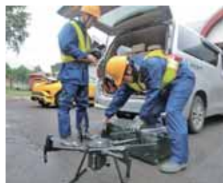
ドローンによる洪水調査
